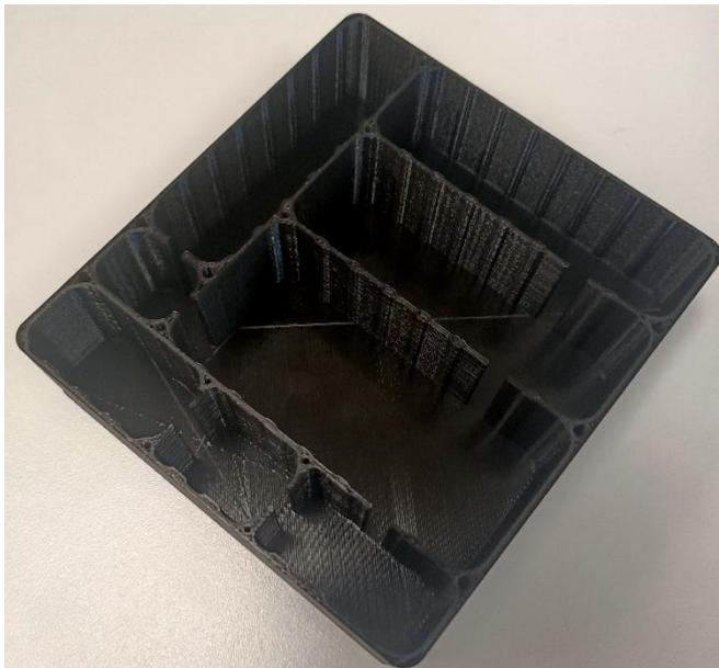
*Figure 4.* Image du boîtier imprimé en 3D. Ce boîtier a été imprimé en 12h avec une buse de 0.6 mm sur une imprimante de type Ultimaker 2+ et du filament PLA noir Ultimaker
