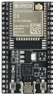
Figure 11. Image d'un ESP32 Devkitc 32UE
